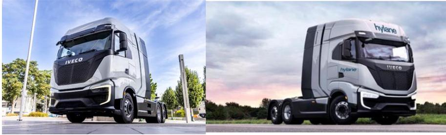
Abbildung 5: IVECO FC Truck; 400 kW, 700bar und 70 kg H2 Tankvermögen
